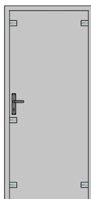
An den Einstellpunkten von Schritt 2 und 3 muss solange justiert werden, bis an allen fünf Messpunkten die Scheckkarte klemmen bleibt. Erst dann ist die Tür richtig und maximal akustisch wirksam eingebaut.
