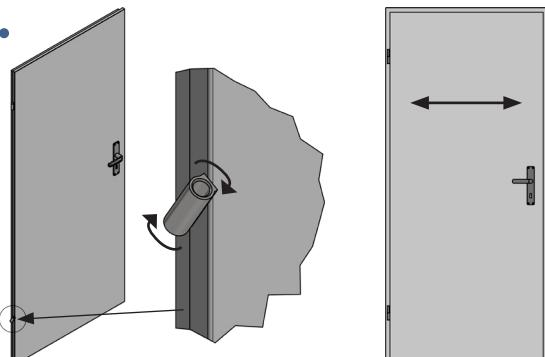
Hängt das Türblatt leicht schräg im Rahmen, lässt es sich über das Drehen der Bänder einstellen. Soll sich das Türblatt weiter zur Schlossseite neigen, drehen hierzu das obere Band gegen die Uhrzeigersinn. Durch Drehen des Bandes im Uhrzeigersinn hebt sich das Türblatt an der Schlossseite.
