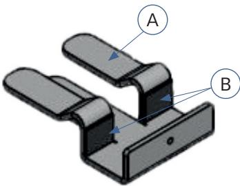
Schaumpads [B] an der Unterseite der Tischklemme soni FIX CLAMP [A] aufkleben.
