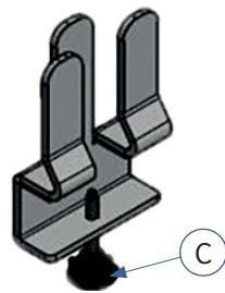
Druckschraube [C] in das Gewinde eindrehen.
